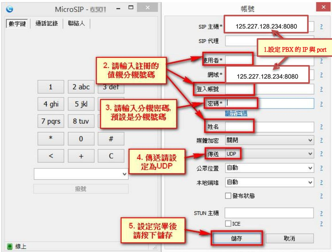
5. 設定完畢並按下儲存後，顯示『線上』表示此分機號碼已與 PBX 註冊成功。
